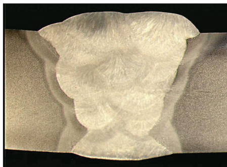
4. kép. Nagy illesztési hézag, csökkentett élézési szög. Egy oldalról, kerámia alátéttel és rutilos portöltéses huzallal hegesztve. (PF heg.helyzet)
