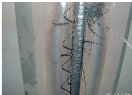
4. kép. Nagy illesztési hézag, csökkentett élézési szög. Egy oldalról, kerámia alátéttel és rutilos portöltéses huzallal hegesztve. (PF heg.helyzet)
