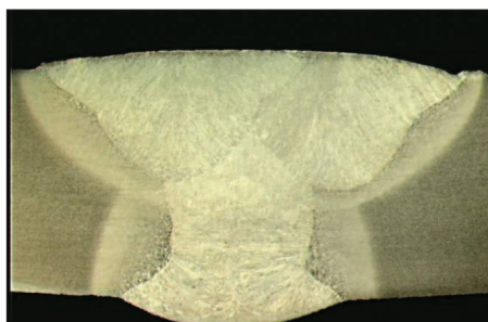
8. kép. Bázikus portöltéses huzallal hegesztett gyöksorok (1-2) kerámia alátétes, fedett ívű hegesztéshez (3-5).
