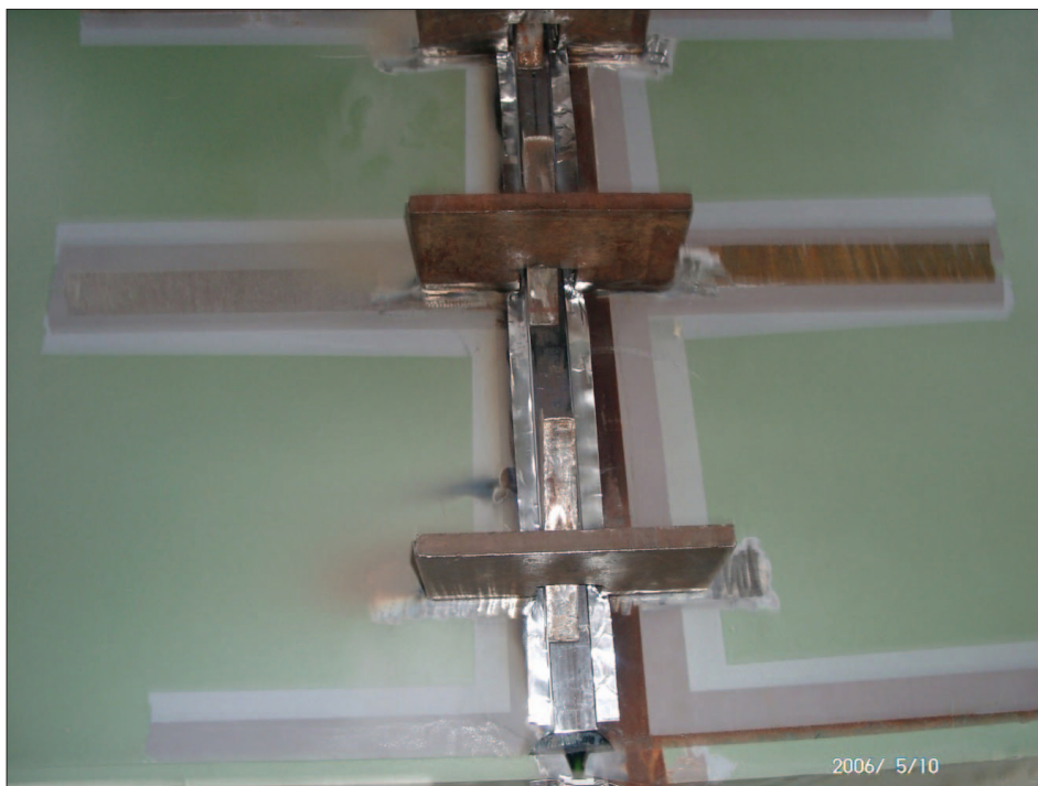
11. kép. Öntapadós rögzítés megerősítése kiékeléssel.
