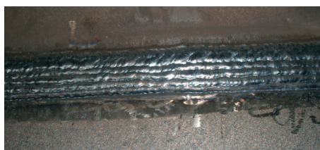
5. kép. Haránt helyzetben hegesztett varrat képe és makrocsiszolata.
