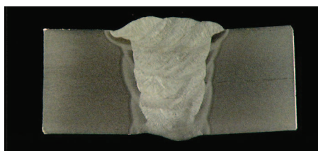
5. kép. Haránt helyzetben hegesztett varrat képe és makrocsiszolata.
