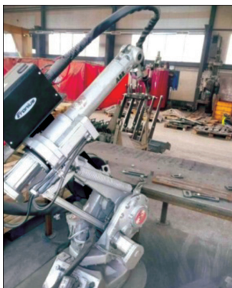
2 ábra. Bemutató robot (ABB) Fronius hegesztőfelszereléssel
