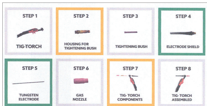
1. ábra – TIG hegesztőfej ismertetéséhez (oktatásához) készített tananyag (Az egyes lépések magyarázatához ez az ábrásor kiindulás lehet).
