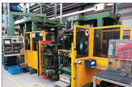
8. ábra: Rofin lézerforrással felszerelt automatikus adagolású hegesztőgép
