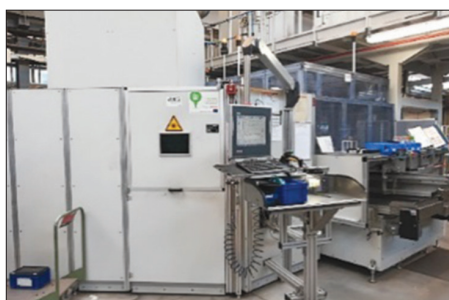
9. ábra: Trumpf lézerforrással felszerelt automatikus adagolású hegesztőgép
