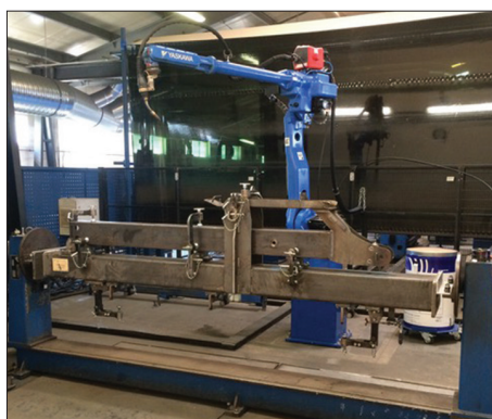
3. ábra. UP20MN robotkar 3,1 m hosszú karkinyúlással
