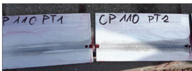
9. ábra CP1000 minőségű, 1 mm vastag lemezekből készült átlapolt kötéseinek makrofelvelete (25x)
