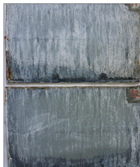
12. ábra. CP1000 minőségű, 1 mm vastag lemezekből készült átlapolt kötéseinek korróziós vizsgálata 48 óra után (vizsgálati oldal, hátoldal)
