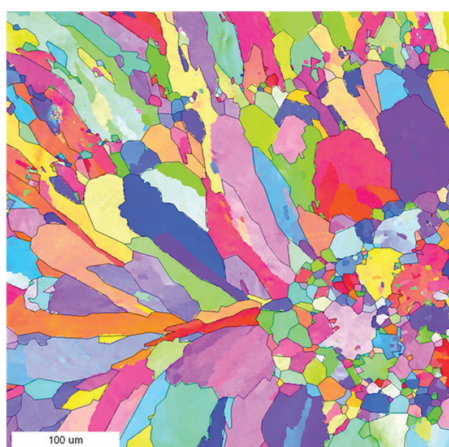
8. ábra Finomszemcsés heglencse és az azt körülvevő dendrites szövetszerkezet (átlagos szemcseméret: 15 μm, kumulatív szemcseméret (90%): 70 μm)
