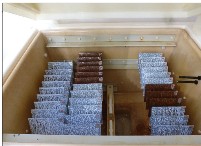
11. ábra. Alapanyagok sópermet vizsgálata 48 h után
