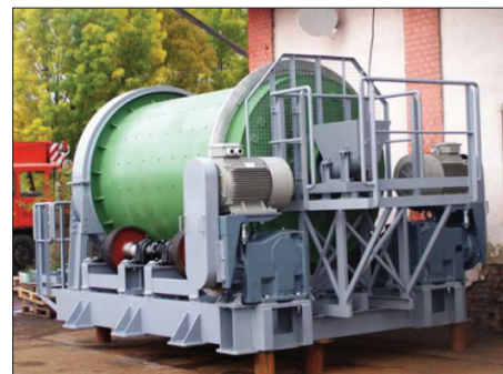
2. ábra Gumigörgőkön alátámasztott kivitel
