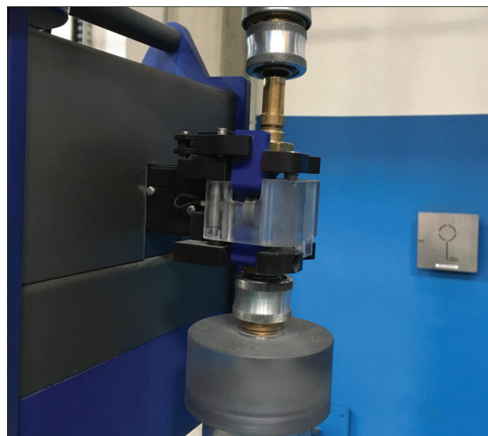
10. ábra. Gyorscsatlakozó a huzalvezetőben
