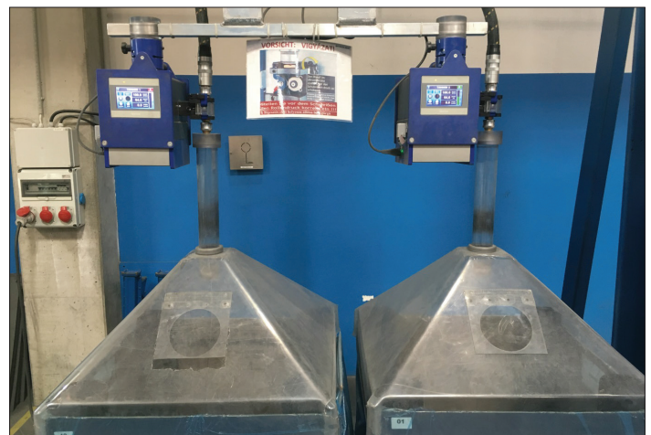
8. ábra. Huzaltovábbítók és hordós kiszerezésű huzalok
