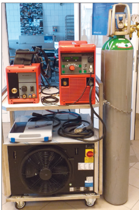
1. kép. Az Arcline®Plus Pole eljáráshoz alkalmazott hegesztőáramforrás, hideghuzal előtoló egység, hűtőegység, valamint a szükséges gázpalackok
