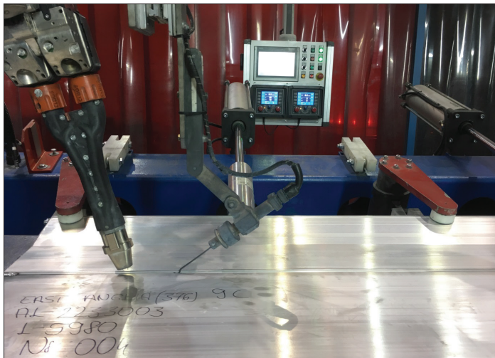
7. ábra. Hegesztőpisztoly és mechanikus varratkövető
