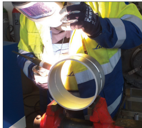
2. kép. Gépi forgatás nélkül végzett klasszikus kézi TIG AC hegesztés (k), valamint a TIG DC+ hegesztés pisztoly pozíciójának beállítása
