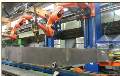
11. ábra. Darugém hegesztő robotrendszer
