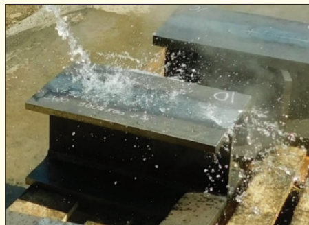
3. ábra. S690QL LV20 I-tartó hevítést követő vízzel hűtése [1]
