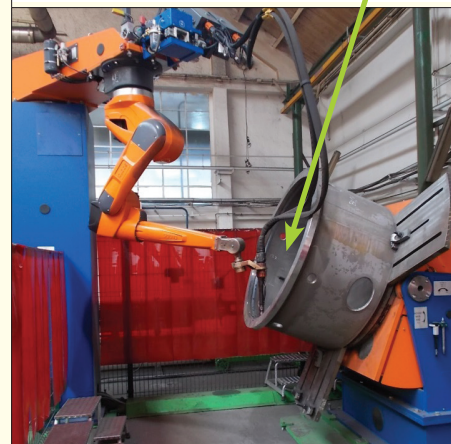
2. ábra. Forgózsámoly karima robothegeesztése
