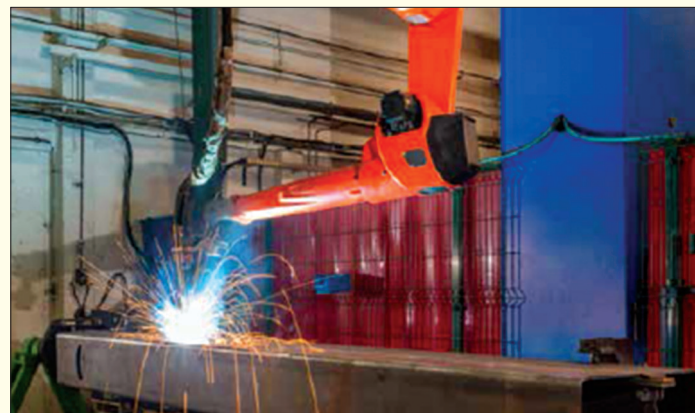
6. ábra: Teleszkópos gép robothegeztése
