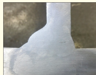
14. ábra. Repedés a varratban
