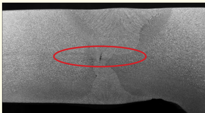
3. ábra: Folytonossági hiba – melegrepedés a varratban
