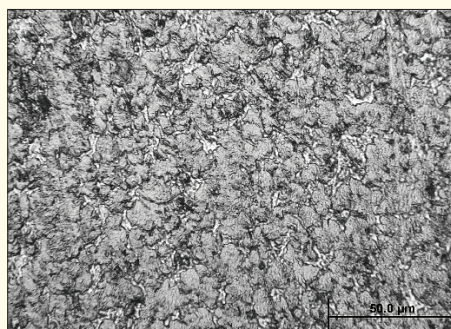
16. ábra. S960QL LV25 vízzel hűtött minta szövetszerkezeti képei alapanyag (a), hevítés hőhatásövezete a felszíntől messzebb (b), és a felszínen (c) [1]
