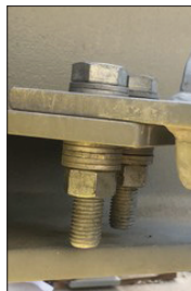
10. ábra. Nem megfelelő méretű csavar alkalmazása, és alátét hegyek
