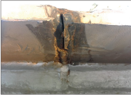
7. ábra. Ennek a hegesztési varratnak teljes keresztmetszetűnek kellene lenni.
