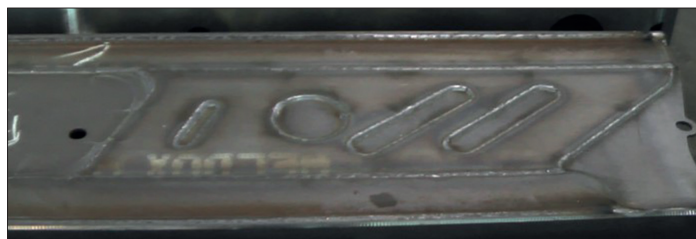
19. ábra. Nagyméretű termék kézzel nehezen hegeszthető vonalvezetésű varratai
