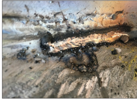
8. ábra. Egy korrózió álló hozaganyaggal készült varrat egy szénacél légvezetéken
