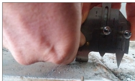
4. ábra. Az éleltolódás több mint 5mm
