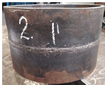
3. ábra: A meghegesztett 2. jelű csőszakasz (külső átmérő 406,4 mm)
