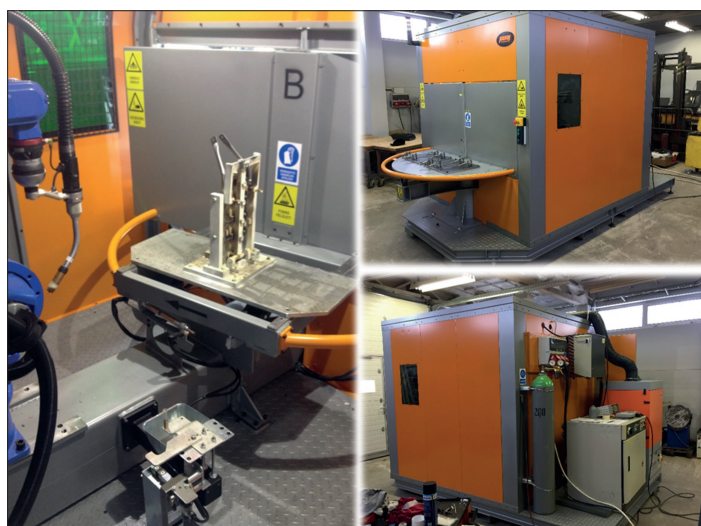
10. ábra. Egyszerű termék egy befogásban, sík asztalon hegesztve
