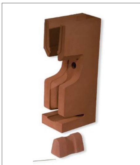
19. ábra: Öntőforma az SRZ-eljáráshoz
