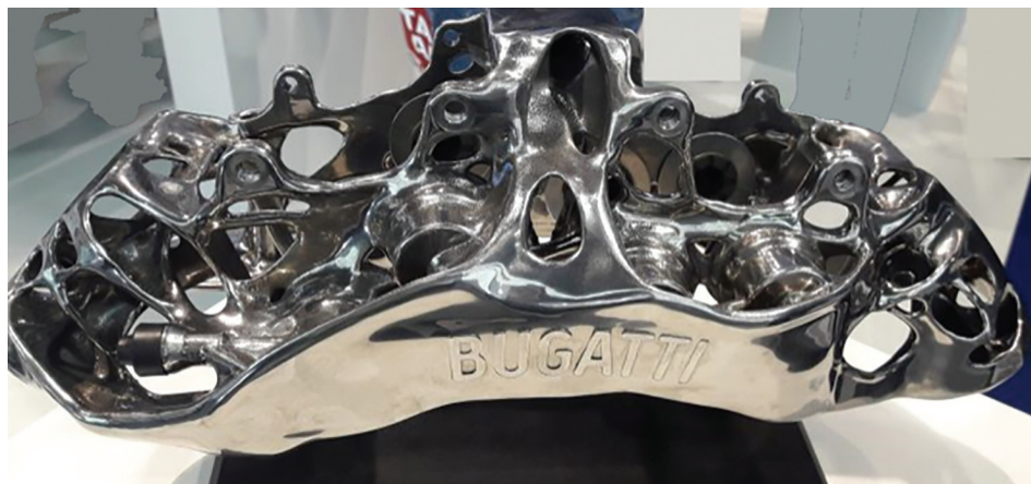
12. ábra. Bugatti Chiron 3D nyomtatással készült féknyereg. Fotó: Halász Gábor
