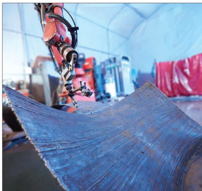
18. ábra. WAAM technológiával készült híd
