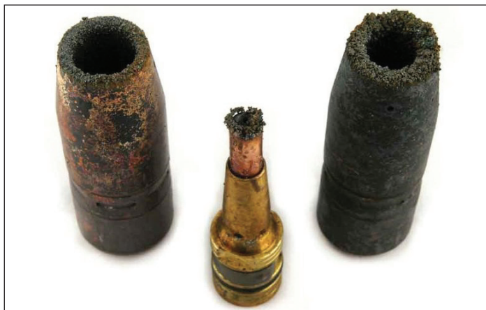
5. kép. A kopó-fogyó alkatrészekben a túlzott fröcskölés miatt kialakuló anyagfelhalmozódás felesleges állásidőt produkálhat, és az alkatrészek idő előtti tönkremenetelét okozhatja.
