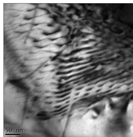
1. ábra. Ultrahanggal hegesztett alumínium próbatestben a diszlokációk rendeződéséről készült TEM felvétele.
