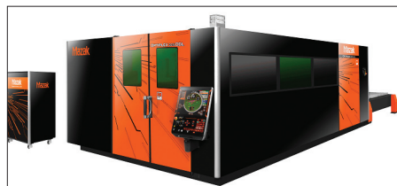
6. ábra. Harmadik generációs lézervágógép DDL sugárforrással
