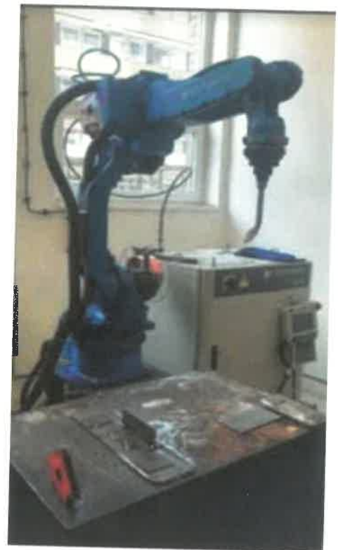
3. ábra: Vizsgált hegesztőrobot
