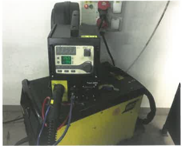
2. ábra: A kísérletben használt huzalelektrodás mikroprocesszoros hegesztőberendezés
