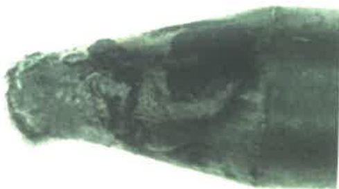
4. ábra: Elektróda és hegfűrdő érintkezésének hatása az elektródacsúcsra (Elektródatípus WCe20, elektródatmérő 2,4 mm.)
