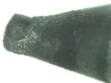
4. ábra: Elektróda és hegfűrdő érintkezésének hatása az elektródacsúcsra (Elektródatípus WCe20, elektródatmérő 2,4 mm.)
