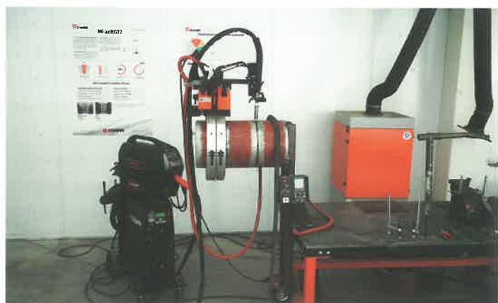
7. ábra: Kemppi-Gullco® egységek csövek gépesített hegesztéséhez
