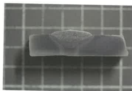
13. ábra: A kötés makroszkópi csiszolati felvétele 6' órai pozícióban
