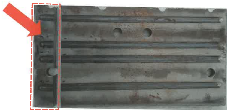
6. ábra: Csiszolati minták készítéséhez levágott darab. (A lemezen látható furatok a cikkben nem részletezett optikai mérésekhez szolgáltak pozicionálására.)
