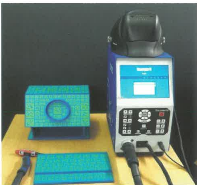
2. ábra: Soldamatic hegesztőszimulátor a munkadarabokkal és a TIG pisztollyal
