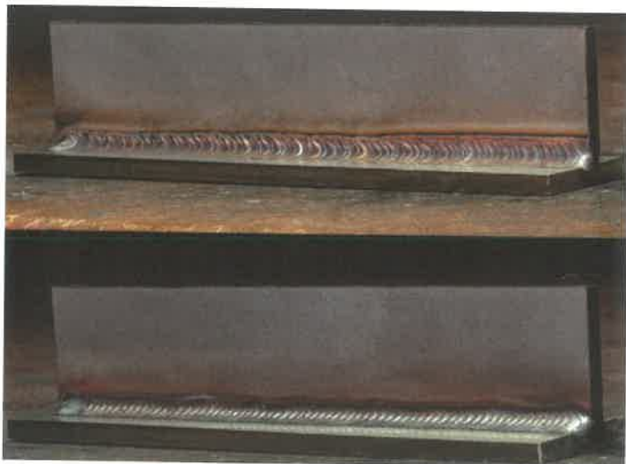
2. ábra: Az összehasonlítás azt mutatja: A MicorTwin (lent) az AWI eljárással egyenértékű varratképet biztosít (fent).
