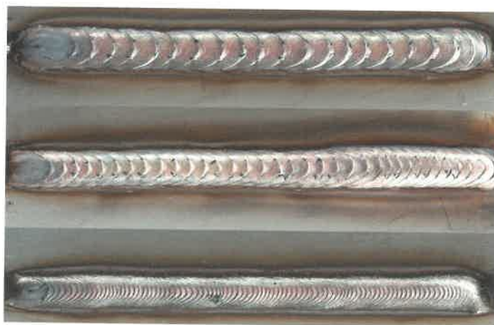
3. ábra: Jobb hegesztési varrat egyetlen gombnyomással: A kívánt varratkép egyedileg állítható a dinamikus vezérlés segítségével - a durva (fent) a normál és a sűrű varratkép (alul) között.
