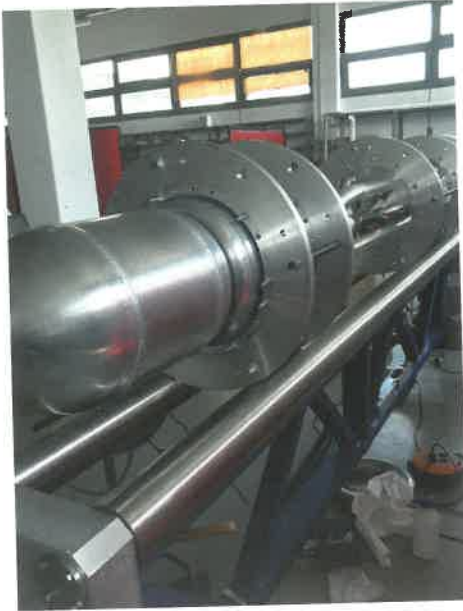
4. ábra: A termoszifon alumínium ötvözetű tartálya a reflektor kamrával az összeállító asztalon
