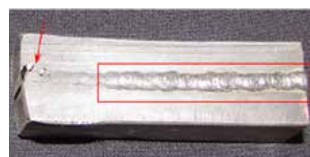
20. ábra: Helytelen varrat kialakítás (E1002A)
