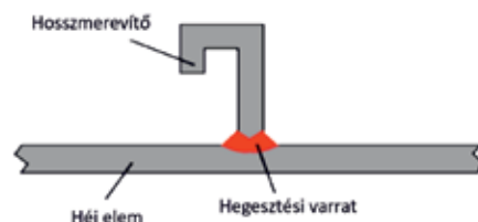
12. ábra: Szegecselt fél-héj szerkezet elem integráció kiváltása hegesztett kötéssel [12]
