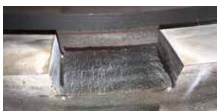
18. ábra: Meghibásodás töretfelülete
