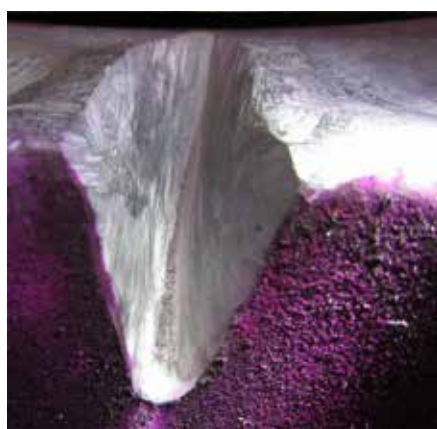
9. ábra: Kimunkált hibamentes hegesztési varrat
