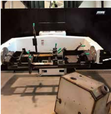
7. kép: Az 5-tengelyes pozicionáló és az első készre hegesztett tartály
