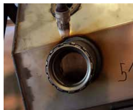
5-6. kép: Tartályvarratok hegesztése, OTC AC/MIG eljárással
