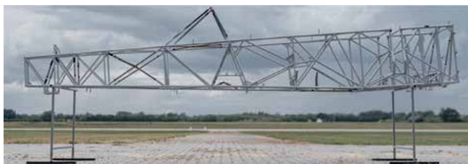
9. ábra: GenPRO hegesztett hibrid titán térrács törzs szerkezeti egység [9]
