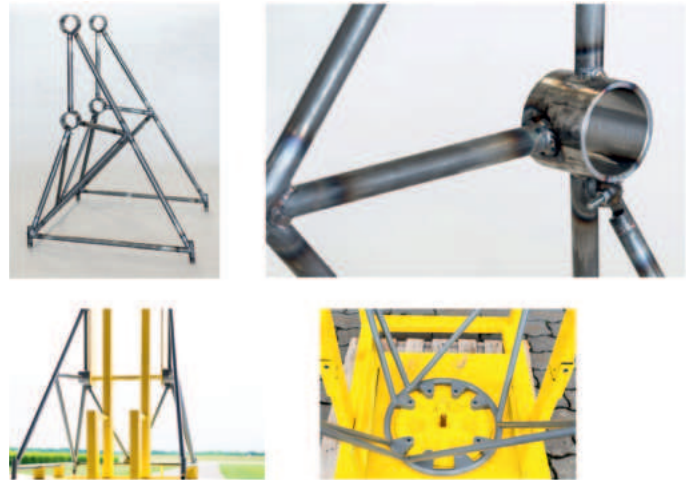
27. ábra: Különböző elkészült hegesztett motorágy szerkezetek a Genevation Aircraft Kft. által elkészítve, Jakabszálláson
