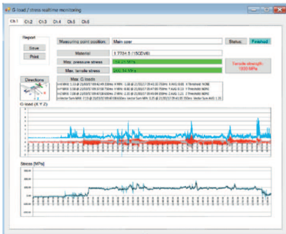
35. ábra: Hegesztett híd – főtartó bekötés repülés közbeni nyúlásmérés eredményei
