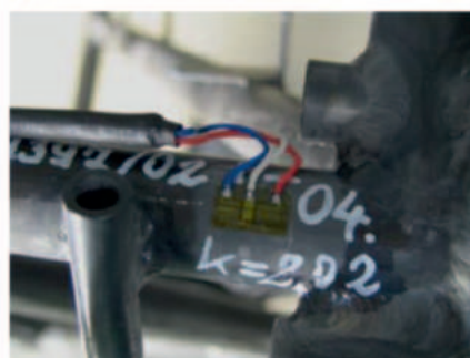
35. ábra: Hegesztett híd – főtartó bekötés repülés közbeni nyúlásmérés eredményei
