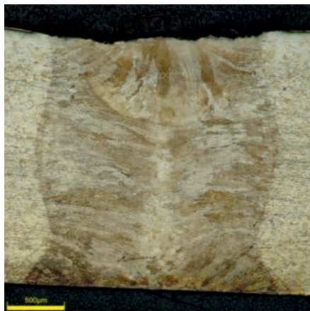
4. ábra: 2500/1000W 8m/min 100x nagyításban
