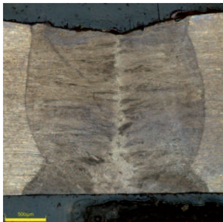
3. ábra: 2500W 8m/min 100x nagyításban
