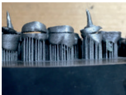
11. ábra: Réteg hiba, részben javítható (lézerhegesztéssel)
