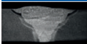
Teljes beolvadású egyoldali tompa V varrat
