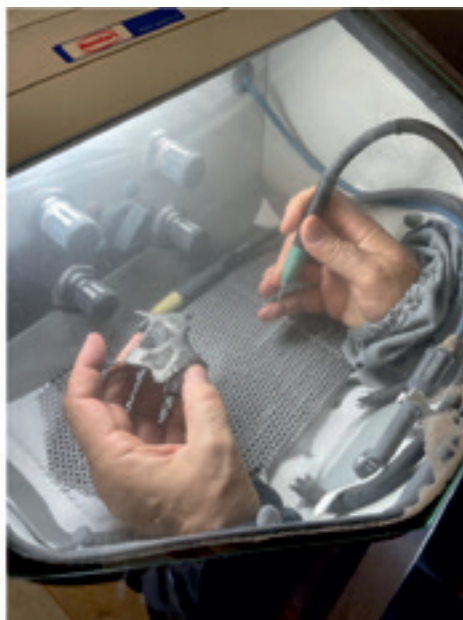
6. ábra: Felület előkészítése porszórással
