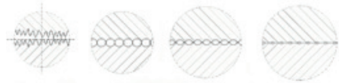
6. ábra: A felületi érdességi profil ellipszis barázdáinak közelítése és modellezése
