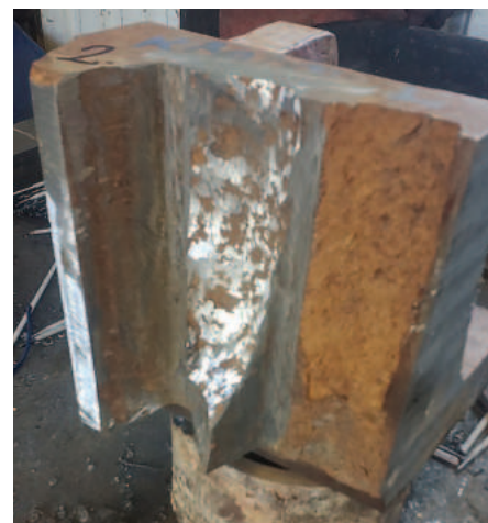
6. ábra A II. technológiával hegesztett fog
