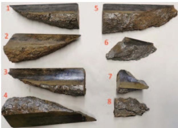
3. ábra Károsodott fogaskerék fog darabok [4]
