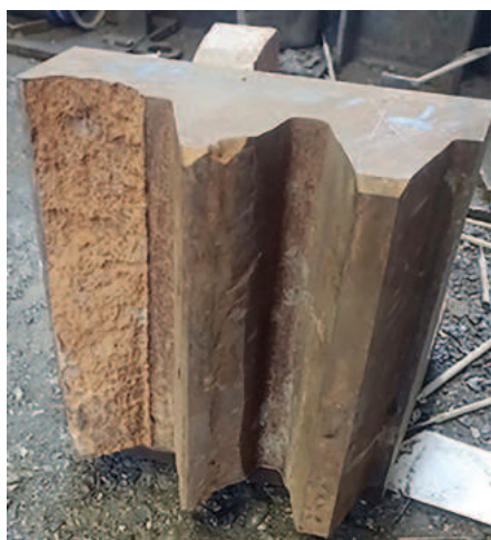
11. ábra A IV. technológiával hegesztett fog
