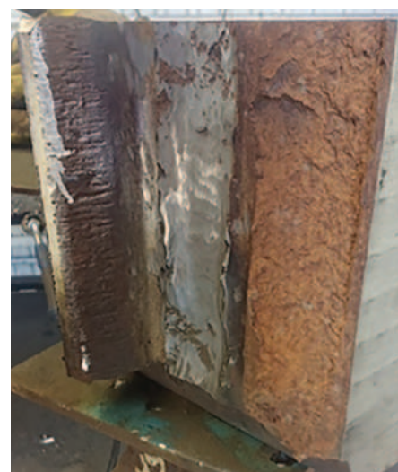
7. ábra A III. technológiával hegesztett fog
