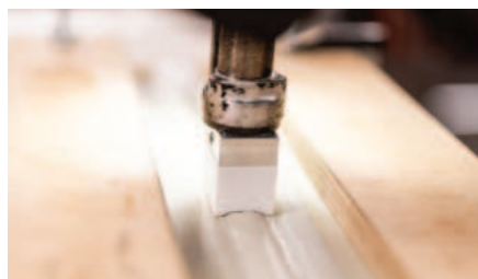
Polipropilén lemezhegesztés extrúziós eljárással
