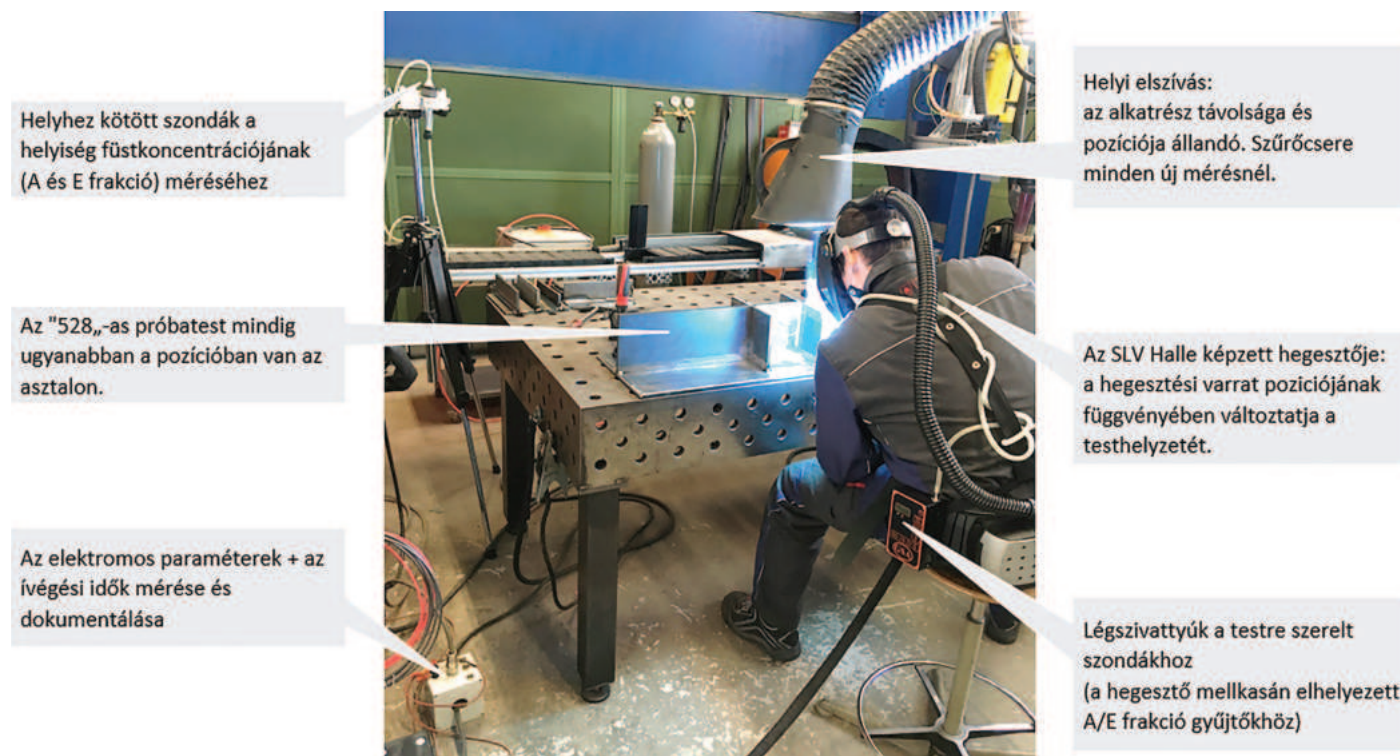
2. ábra Az „528”-as próbatest hegesztése, reprodukálható munkahelyi körülmények között valamint a BGHM szabványosított hegesztésifüst expozíció mérés körülményei
