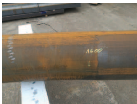
4. ábra Hajlított cső egyenes (kör) és íves (ovális) szakaszának átmenete (Eger patak)
