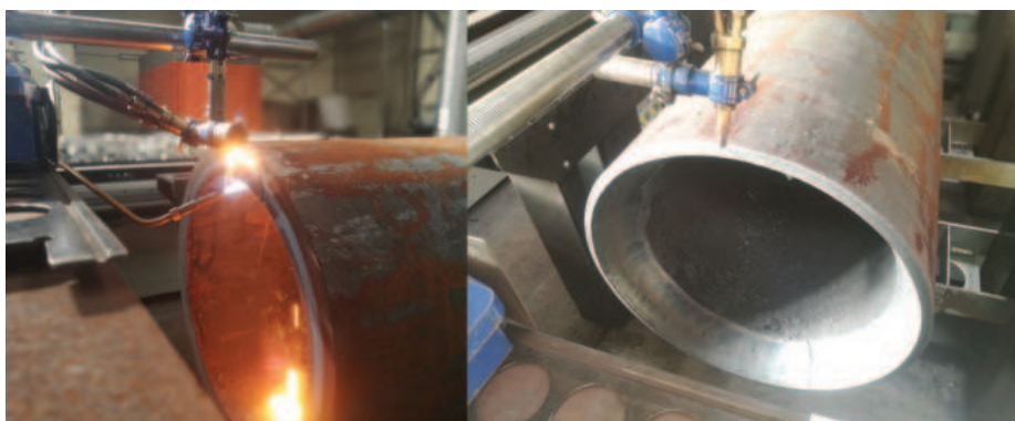
2. ábra Vastagfalú cső leélezése forgatóban
