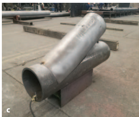
7. ábra Főtartó csatlakozása a) 3D plazmavágás b) próbavágás alkatrészei c) próba összeállítás d) hídelem részegység gyártása (Tisza híd)
