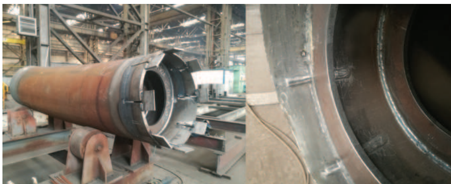
3. ábra Dimenzió eltérés korrigálása koronás feltágítással (Eger patak)
