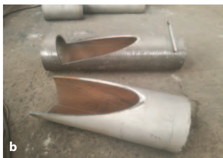
6. ábra Íves tartó gyártása a) 12m-es egyenes cső toldása b) hajlított tartó helyszíni szerelése (Myslenice)
