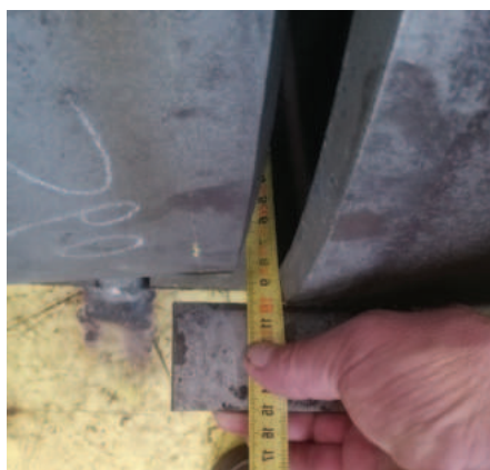
1. ábra NA610 csövek közel falvastagságot elérő dimenzió eltérése
