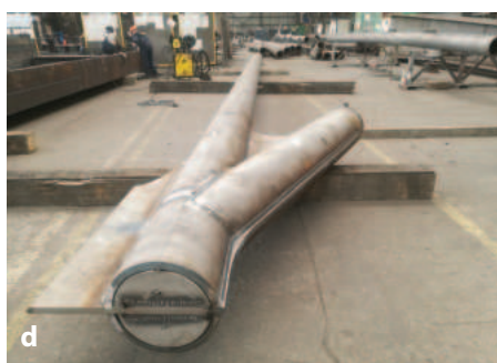
7. ábra Főtartó csatlakozása a) 3D plazmavágás b) próbavágás alkatrészei c) próba összeállítás d) hídelem részegység gyártása (Tisza híd)
