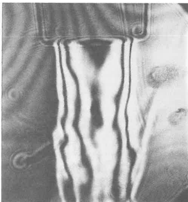
8. ábra. MB 501 kónuszos kialakítású gázfúvókával (gázmennyiség 15 l/min). A lamináris gázáramlás igazolja a gázfúvóka és a beállított gázmennyiség helyes kombinációját.
