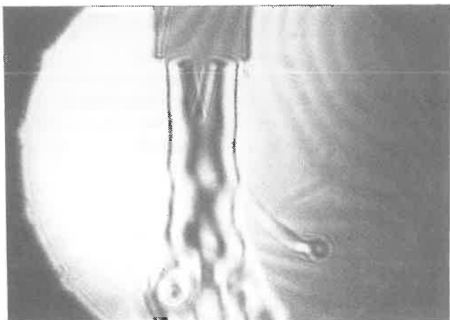
3. ábra. Gázlencsés pisztoly (SR 18 gázátfolyás: 8 l/min). A gázlencse a pisztoly belsejében egy örvénymentes, lamináris gázáramlást tesz lehetővé, amely kisebb gázfogyasztás mellett jobb gázvédelmet szavatol. Az örvénymentes áramlás következtében nem jut be levegő a környezetből.
