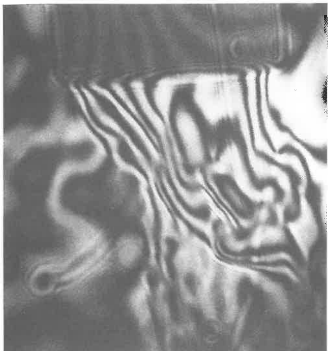
5. ábra. MB 501 típusú hengeres kialakítású gázfúvóka (gázmenyiség 15 l/min). Az ábra a gázáramlást 1 m/s nagyságú oldalszélénél mutatja. A gázvédelmet nem lehet szavatolni.
