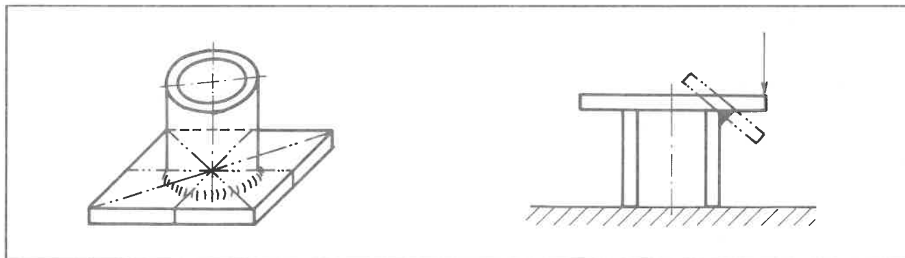
4. ábra. Sarokvarratok tőretvizsgálata csöveken.
