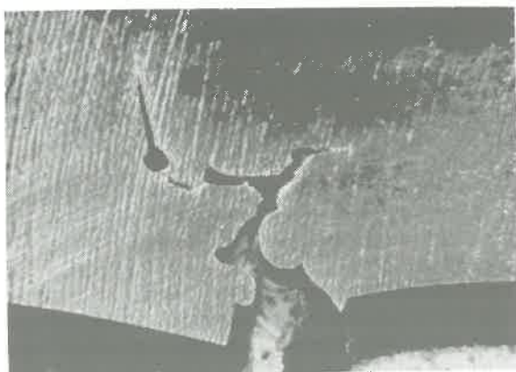
2. ábra. Tokrepedés gyártási hibából.
