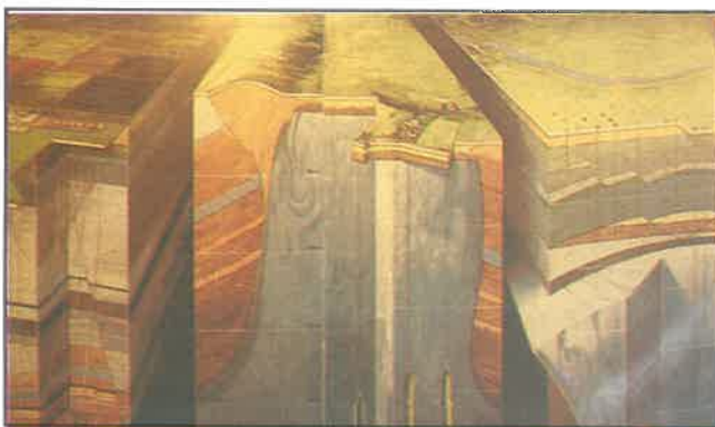
2. ábra. A föld alatti tároló kavernák helyzete és kialakításuk.
