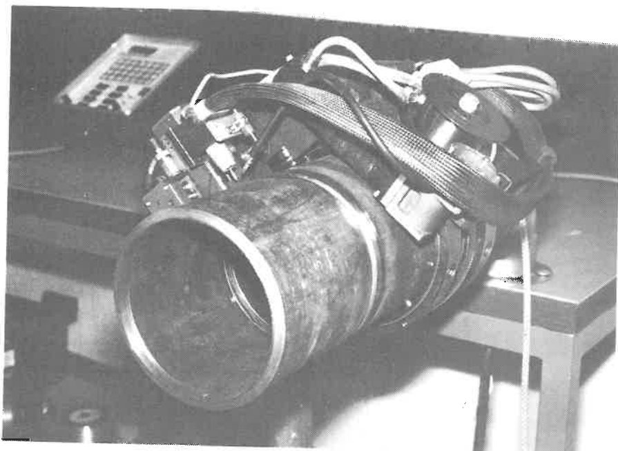
5. ábra: Polycar típusú hegesztőfej 168 mm-nál nagyobb külső átmérőjű csövekhez, AVC feszültség vezérléssel, keresztirányú mozgattal és beépített huzaladagolóval (Polysoude)
