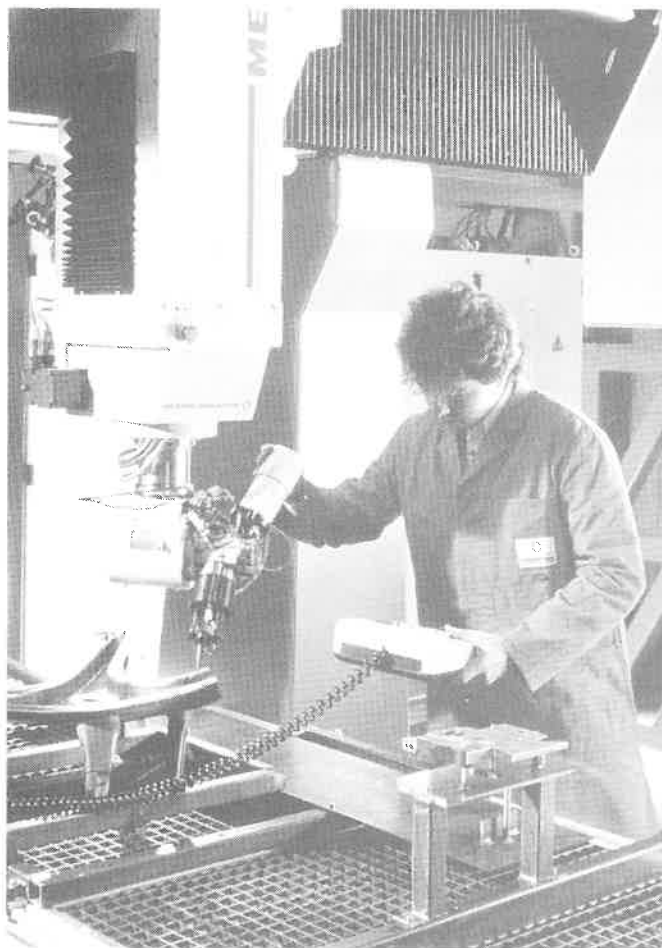
10. ábra Teach in programozás – a hegesztési körvonal hagyományos programozása mellett sok felhasználó alkalmazza a programozó munkahelyet és a mérőberendezést (47.60.58a)
