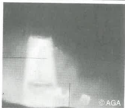
2. ábra: Moderált szóró ív, RAPID MELT, nagyon keskeny és nagyon mély beégés
