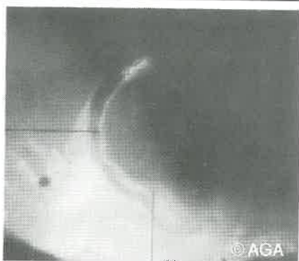
3. ábra: Forgó-szóró ív, RAPID MELT, széles varrat, nagyon jó szegély-beolvadás
