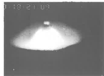
3. ábra Az impulzusív a csúcsáram szakaszban
