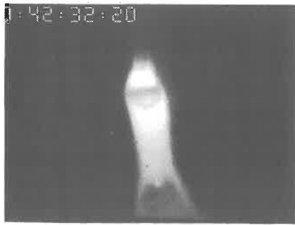
6. ábra Túlzottan nagy alapáram miatti szabálytalan cseppátvitel
