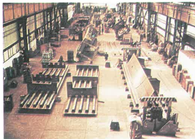
5. kép. A szerkezeti egységek összehegesztésére berendezett műhelyrész előfeszítő-forgató berendezésekkel
