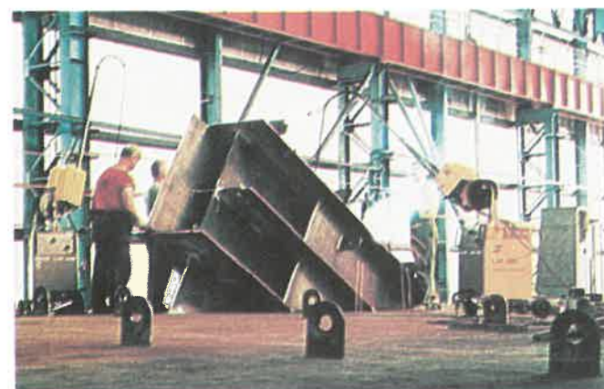
7. kép. A ferde bekötő rúd bonyolult kialakítású csonkjának előszerelésekor történő összeállítása és hegesztése
