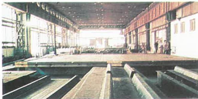
3. kép. Állítópád a felhegesztendő hosszboardák és keresztartók helyének berajzolásához (az előtérben fekvő egységek már felfűzött trapézboardákkal)
