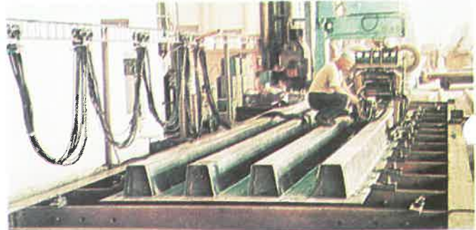
4. kép. A trapézboardák felhegesztése kétfejes ESAB fedettívű automatával előfeszítő-hegesztő készüléken
