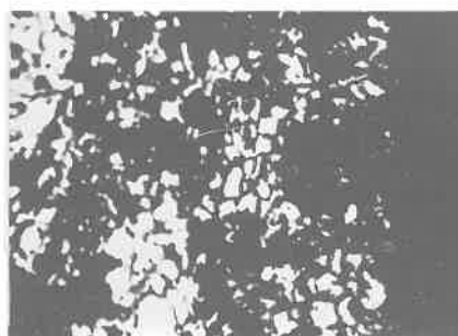
7. ábra. A387-Gr.XII acél mikroképe lézersugaras vágás után
