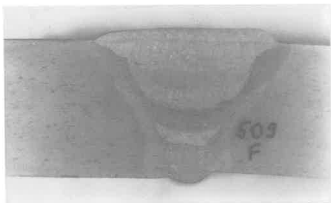
3. ábra Az orbitálfejjel hegesztett varrat makroszkópi csiszolatának felvétele
