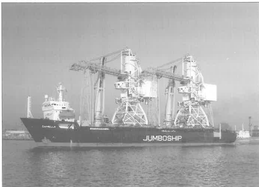
3. kép 300 t/óra teljesítményű pneumatikus bauxitkiváló daruk szállítása alatt (1993)
