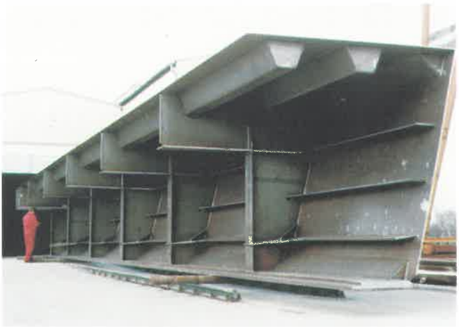
2. ábra RAPID ARC™ technológiával hegesztett hídszerkezet Fig. 2. Bridge made using RAPID ARC™ technology
