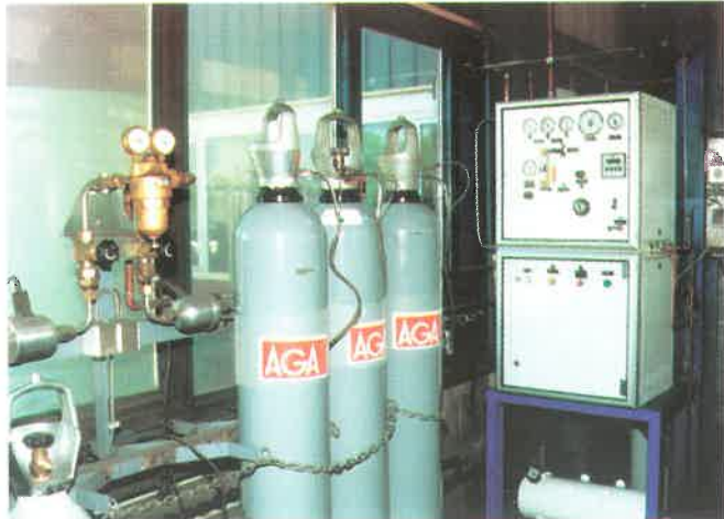
3. ábra MISON® gázellátó rendszer részlete a háromkomponenses gázkeverővel Fig. 3. The MISON® 8 gas supplying system with a three component mixer
