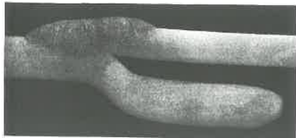
5. ábra. Kéthuzalos, 6 m/min sebességű hegesztéssel készített varrat
