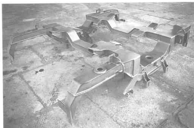
7. kép. Bonyolult kialakítású forgóvázkeret
