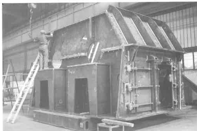
15. kép Kötőrő berendezés acélszerkezete
