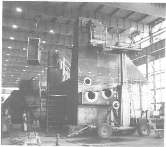
22. kép Radar lokátor ernyőtartó egységének műhelyi próbaszerelése
