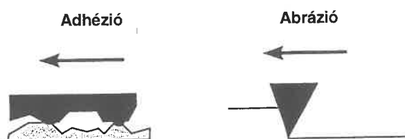
2. ábra. Az abrázió és adhézió koptató mechanizmus vázlatos bemutatása
