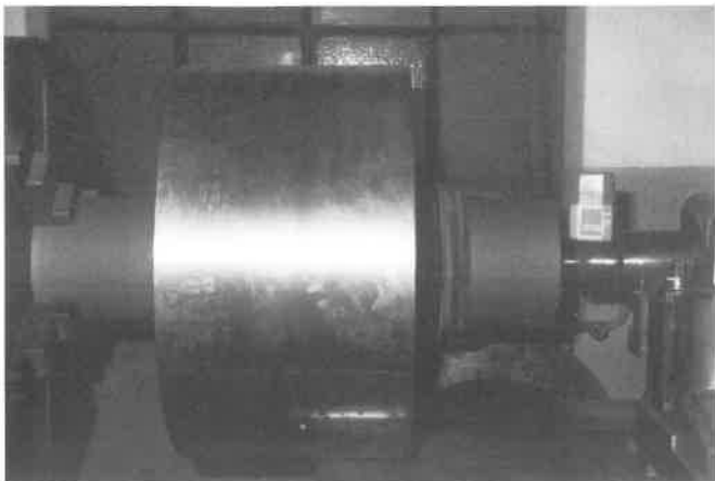
8. ábra. Cementgyári kemence vezetőgörgője Csapágycsapok javítása por-lángszórással
