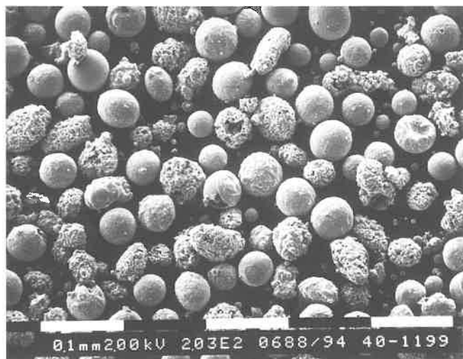
6. ábra. Agglomerálással és szinterezéssel gyártott Cr 3 C 2 -NiCr-por
