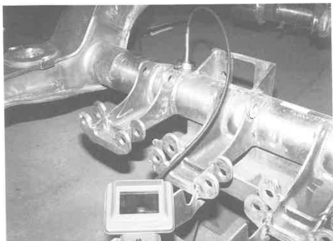
2. kép. Csőkereszttartó – hossztartó kapcsolat részlete
