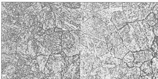
7. ábra A HT 80 és HT 100 acél varratági zónája, amelyet egy utóhőkezelést szimuláló hőciklusnak vetettek alá.
