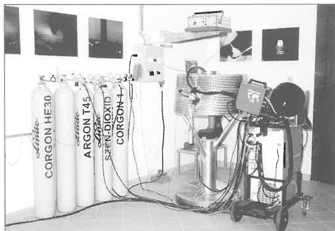
4. ábra. „Ívprojektor” a hegesztési folyamatok szemléltetéséhez
