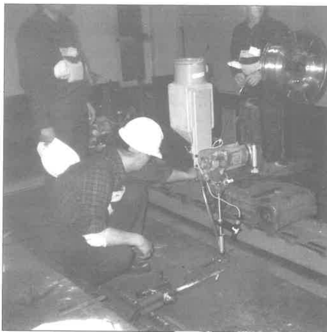
5. ábra. A hegesztőkocsi fotója
