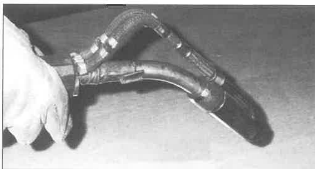
4. ábra. T.I.M.E. pisztoly külső hűtéssel
