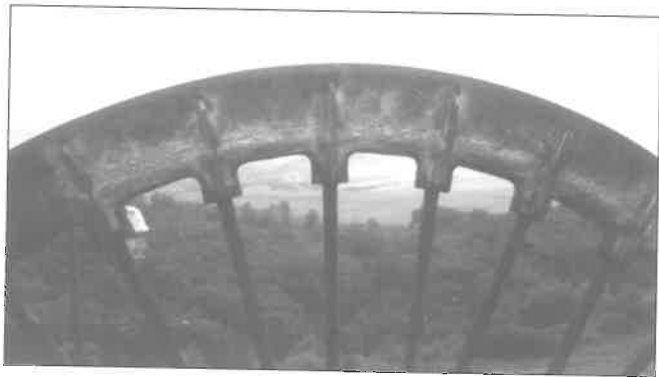
9. ábra. A kötélkorong javított varrata az erősítő bordákkal
