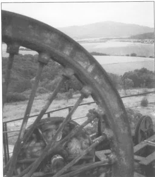
1. ábra. A kötélkorong repedt varrata
