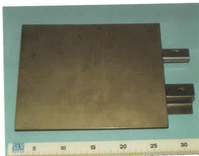
3. A pontszerű forrasztott kötés mintái
