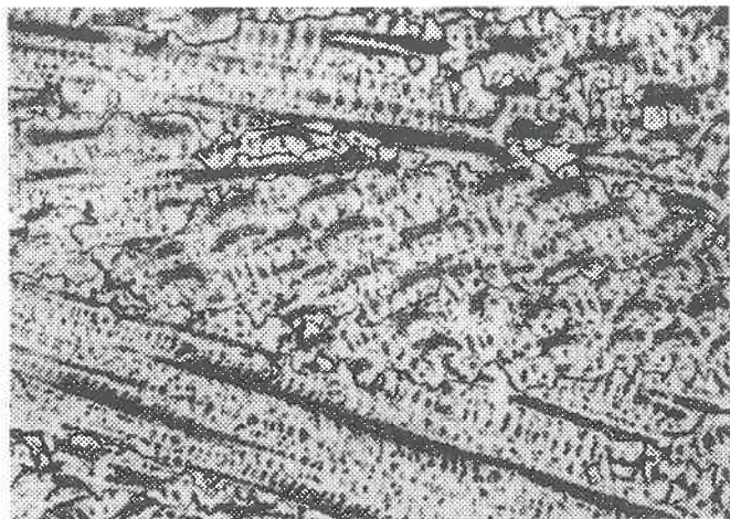
8. ábra. N=250\times Marószers: glicerines királyvíz; Kobalt alapú 5% Mo tartalmú felrakott réteg szövetszerkezete
