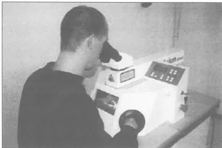
1. ábra: Jellemzőes, impulzus üzemű Nd:YAG lézeres kézi munkahely
