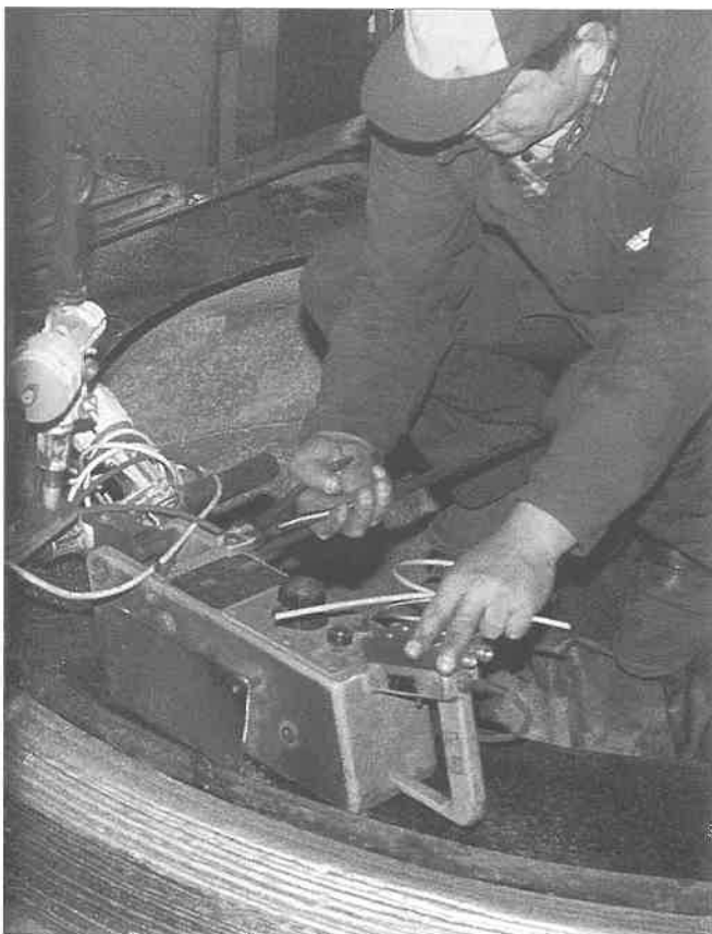
11. ábra. A ház külső kúpfelülete felhegesztett állapotban
