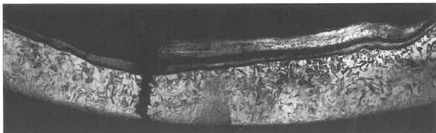
7. ábra. A repedés környezetének szerkezete
