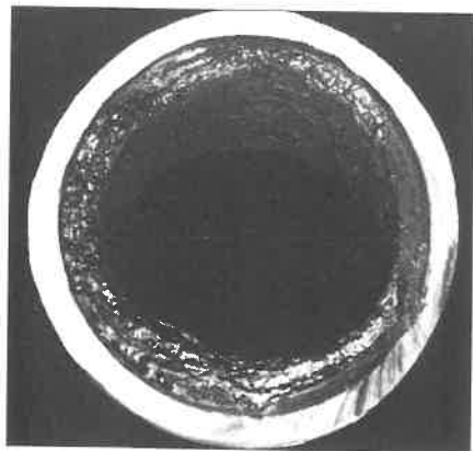
1. ábra. 20 mm vastag kokszt lerakódás a bontó csővének falán
