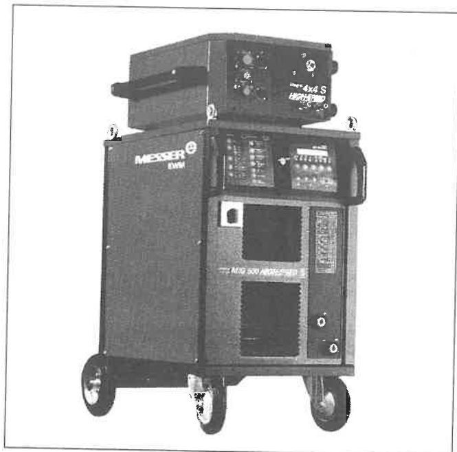
4. ábra. Aktív védőgáz, fogyóelektródás, nagyteljesítményű inverteres áramforrás
