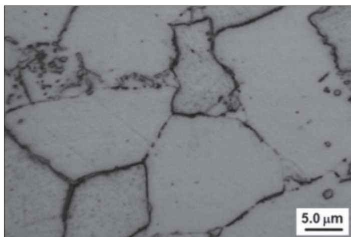
3. ábra: Ferrites acél mikroszerkezete kemencében való lehűtés esetén [1]
