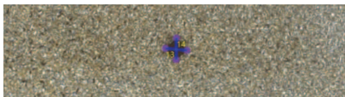
3. ábra A Zeiss Axio Observer Z1m szoftver segítségével a lenyomat átlóinak jelölése
