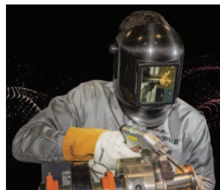
2. ábra Kézi lézeres hegesztő biztonságos egyéni védőfelszereléssel
