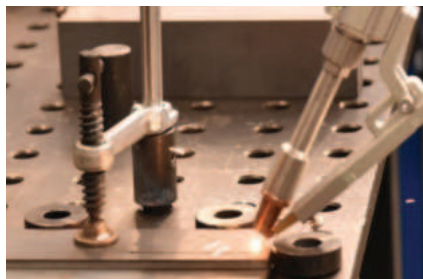
7. ábra A H2-es hernyóvarrat hegesztése 300 W lézerteljesítménnyel
