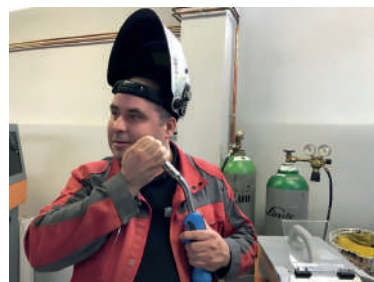
2. ábra: A gázmennyiség beállítás hallás, érzékelés alapján. Helytelen!
