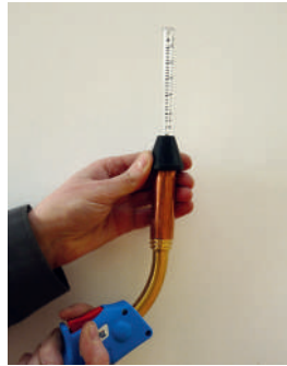
4. ábra: A gázáramlás mennyiségének beállítása átfolyásmérő (rotaméter) segítségével
