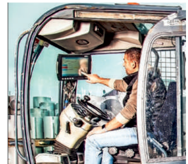
TYSON (Trailer Yardmanagement System Online); GPS alapú terméklokációs rendszer, mely a kész járművek telephelyi pozícióját rögzíti gyártási szám alapján, illetve a pótkocsimozgató járműveket navigálja
