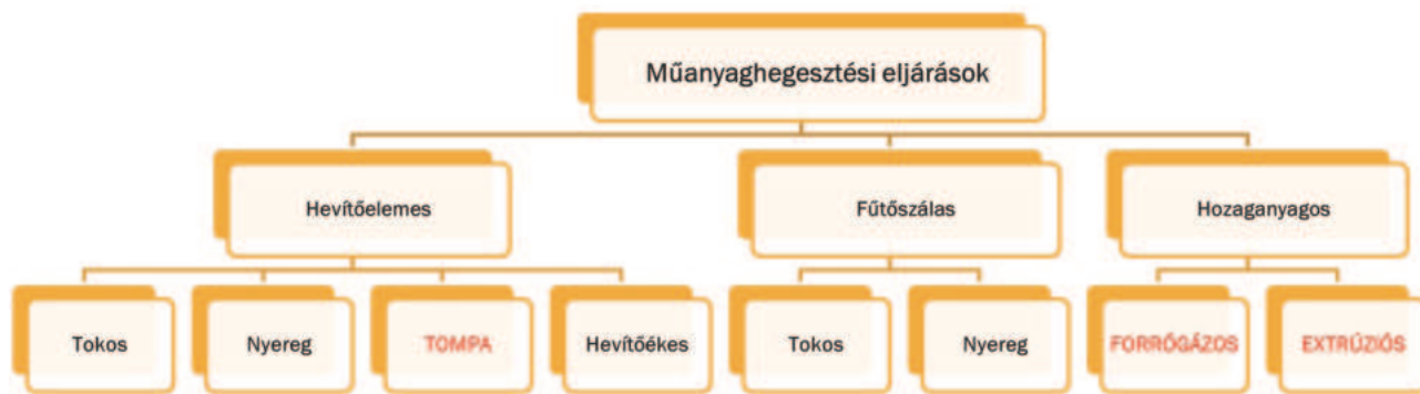
6. ábra Az ipari gyakorlatban leginkább elterjedt cső és lemez műanyaghegesztési eljárások [5]
