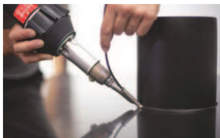
7. ábra Forrógázos hegesztés gyorshegesztő fűvókával [6]
