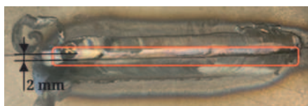
4. ábra: Hibás FSW-ett varrat (5. számú)
