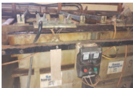
13. ábra Merevítéssel ellátott galvánkádak [11]
