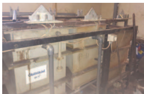
13. ábra Merevítéssel ellátott galvánkádak [11]
