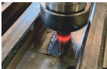
5. ábra: Bedöntött szerszámmal és 1400 1/min-es fordulatszámmal végzett kaváró dörzshegesztés folyamata
