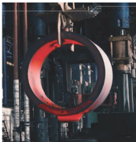
1. ábra Reaktortartály csatlakozó csomópont sajtolása, gyártási állapot (NA850) (forrás: ROSATOM)
