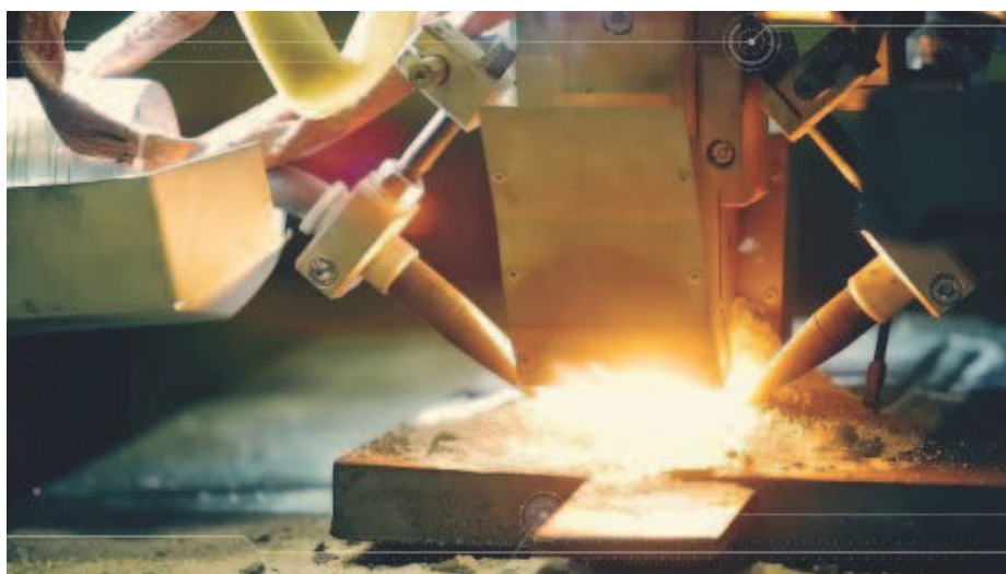
2. ábra Fedett ívű szalagelektrodás felrakóhegesztés munkarendi utasítás vizsgálata (forrás ROSATOM)
