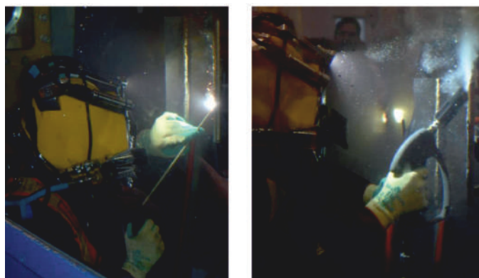
5. ábra A vízalatti (búvár)hegesztési technológia technikai háttere és „élő” bemutatója
