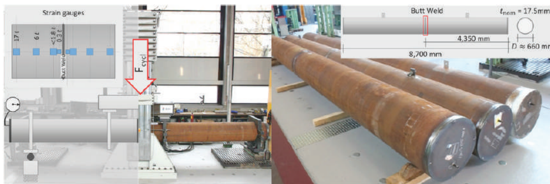
6. ábra A BAM Berlinben a tompahegesztett csöveken végzett fáradásvizsgálatokhoz használt próbatestek geometriája és a próbatestek helyzete, a nyúlásmérők helye
